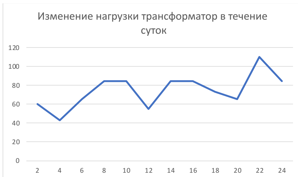
Рисунок 11 – Изменение нагрузки трансформатора в течение суток
