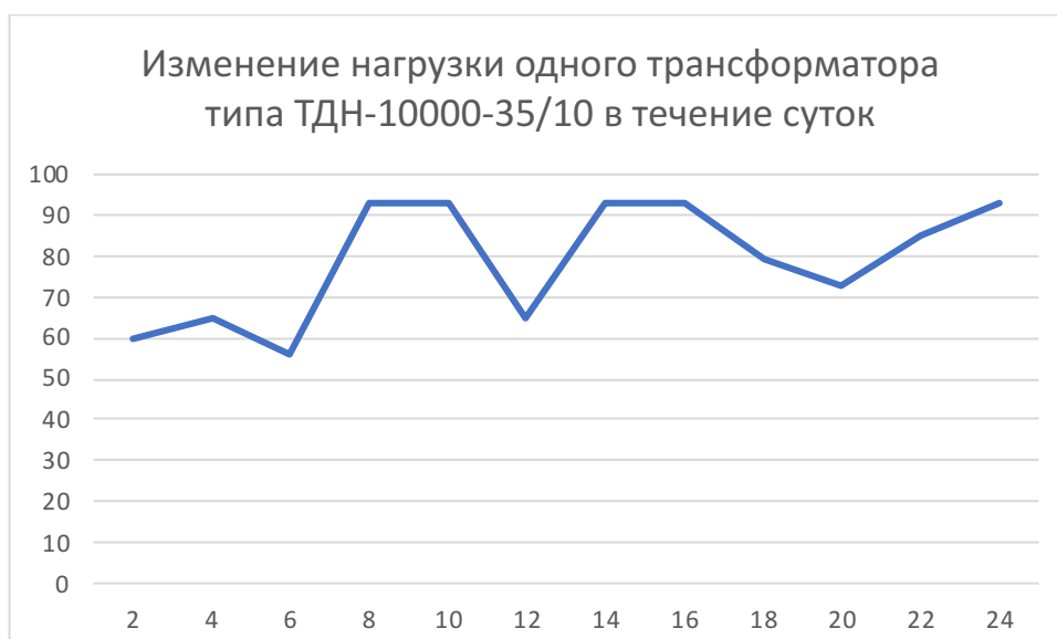
Рисунок 10 – Изменение нагрузки одного трансформатора в течение суток
